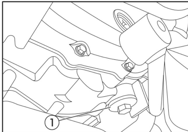
3. Após a drenagem, coloque a motocicleta em posição vertical por aproximadamente um minuto para drenar o óleo remanescente no motor;
