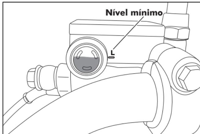
Com a motocicleta na posição vertical, posicione o guidão de forma que a tampa do reservatório de fluido do freio dianteiro fique em posição horizontal e verifique se o nível de fluido está acima da marca "L", de nível mínimo.
