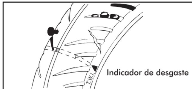
Se o indicador de desgaste ficar alinhado com o relevo da banda de rodagem, significa que o pneu atingiu o seu limite de uso e deve ser substituído imediatamente por um novo.
