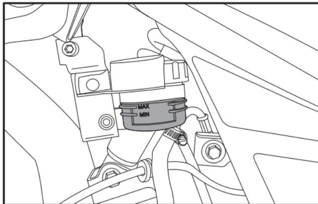
Com a motocicleta na posição vertical, verifique se o nível de fluido no reservatório de fluido do freio traseiro está entre as marcas "MIN", de nível mínimo, e "MAX", de nível máximo.
