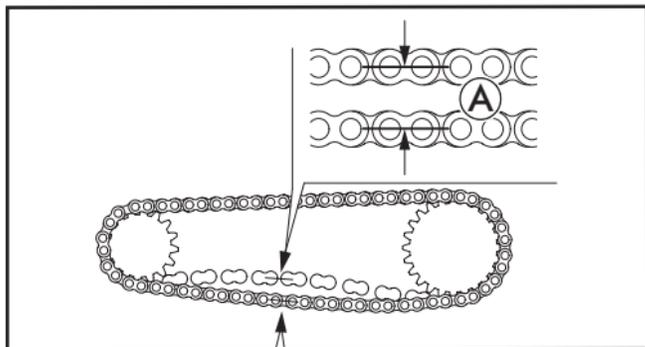
3. Gire a roda traseira para inspeção em vários pontos. Se necessário, ajuste;
