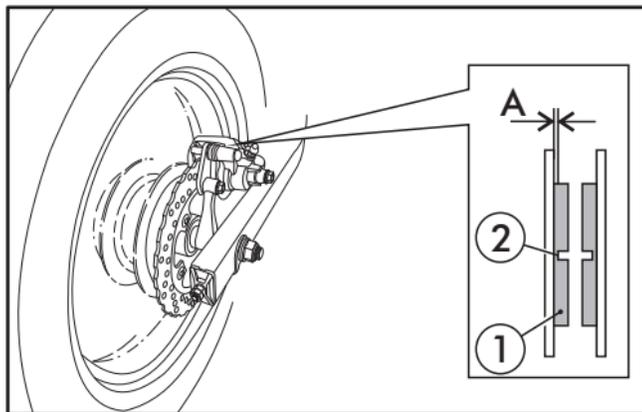
As pastilhas de freio (1) possuem sulcos indicadores de desgaste (2), os quais possibilitam fácil inspeção visual sem necessidade de qualquer tipo de desmontagem.
