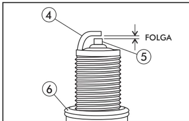
5. Instale e rosqueie a vela de ignição (2) manualmente até que a arruela de vedação (6) encoste no cabeçote e então aplique o torque especificado;
