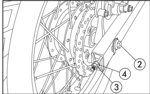
6. Após o ajuste, fixe a cabeça do eixo traseiro (2) e aplique o torque especificado à porca (1);
