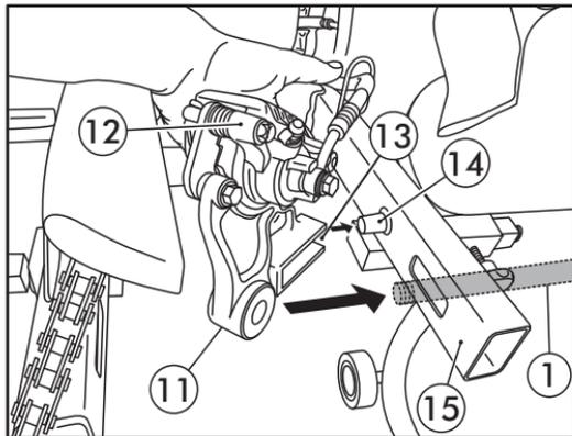
1. Instale os espaçadores direito e esquerdo nos orifícios do cubo da roda;
