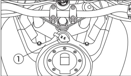
Tomada USB para acessórios (1) fica na parte superior da carenagem do tanque de combustível. Você pode usar essa tomada para energizar acessórios como PDA, rádio ou celular, etc.
