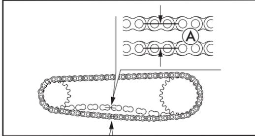
3. Gire a roda traseira para inspeção em vários pontos. Se necessário, ajuste;
