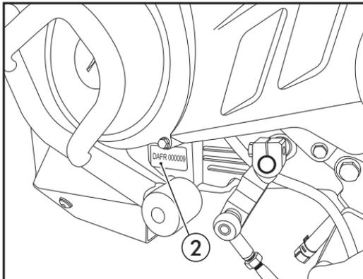
O número de identificação do motor (2) encontra-se gravado na parte inferior da carcaça esquerda do motor, próximo ao pedal de câmbio.
