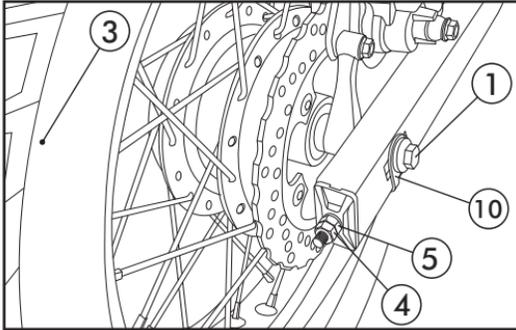
7. Remova o suporte adequado, apoie a roda traseira (3) no solo, fixe a cabeça do eixo traseiro (1) e aplique o torque especificado à porca (2).
