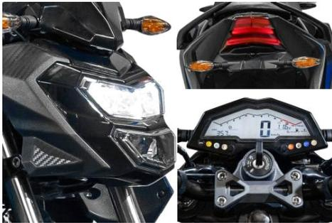
O modelo traz muito da tecnologia e das especificações da consagrada SYM NH 190, como o conjunto de iluminação full LED, painel full digital, carregador USB, o confiável motor monocilíndrico 4 tempos de 183cm<sup>3</sup> e arrefecimento líquido, que entrega 18cv de potência e torque de 1,60 kgf.m, além do câmbio de 6 marchas, excelente opção na categoria.
